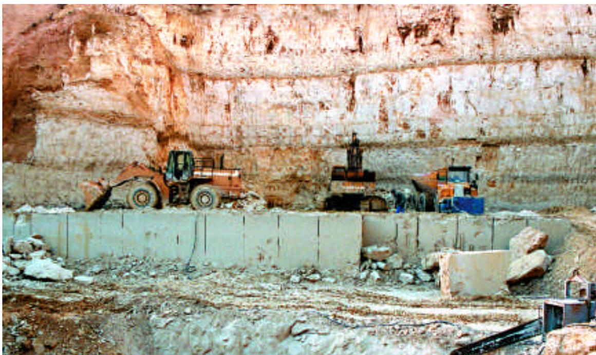
▲ Vue d'un des deux fronts de taille de la carrière de Tuffeau d'Usseau où les quatre bancs sont facilement identifiables. La pierre de taille est située au dernier niveau
