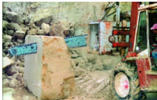
▲ Avant d’être remontés à l’atelier ou sur l’aire de stockage, les blocs sont équarris et redimensionnés sur place à l’aide d’un bras de haveuse de 2,30 m du constructeur Blanc monté sur un chariot élévateur Manitou.
