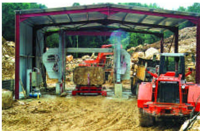
▲ La carrière est dotée d'un bâtiment couvert abritant la machine à fil stationnaire. Outre une autre machine à fil de carrière, les responsables du site utilisent une pelle de 45 t, une chargeuse Fiat-Hitachi et un tombereau.
