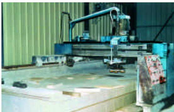
▲► Le nouvel atelier dans lequel est surtout travaillée la pierre de Haims est équipé d'un polissoir à plat GB 520 Thibaut d'une capacité de 2 x 8 m, d'une débiteuse Cèbe-Escande Ø 1 m dotée de trois tables tournantes et programmables. Ces équipements sont alimentés par un pont roulant de 5 t Sidobre Service Maintenance.
