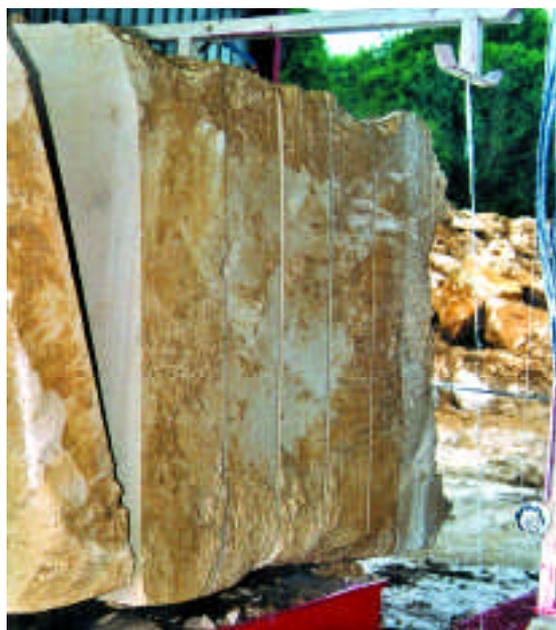
▲ Les deux responsables de la carrière de Haims devant la machine à fil Cèbe-Escande installée en février dernier et servant à la production de tranches épaisses et à l'équarissage des blocs.
